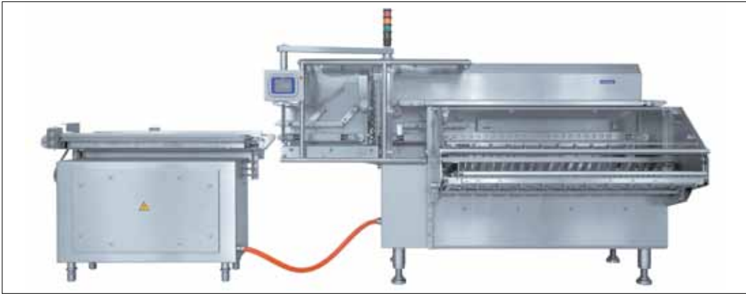
Abb. 4: Pellmaschine vom Typ Weber CCP: Durch eine klare Trennung von Grau- und Hygienebereich wird eine Verkeimung durch die Pelle vermieden. Im Hygienebereich wird die Luft durch ein UVC-Umluftgerät (1) konditioniert und ein UVC-Strahler (2) entkeimt das Übergabehand. Der Messerkopf (3) wird zusätzlich nach jedem Schnitt desinfiziert.
