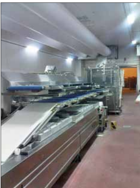
Abb. 1: UVC-Strahler an einem Slicer der Baureihe 904: An zehn Positionen der CCU und des Einlegers wurden UVC-Strahler montiert. Die Positionierung unterhalb der einzelnen Bänder führt zu hygienischen Oberflächen bei laufender Produktion.
