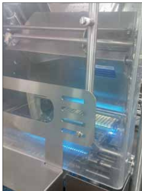
Abb. 1: UVC-Strahler an einem Slicer der Baureihe 904: An zehn Positionen der CCU und des Einlegers wurden UVC-Strahler montiert. Die Positionierung unterhalb der einzelnen Bänder führt zu hygienischen Oberflächen bei laufender Produktion.
