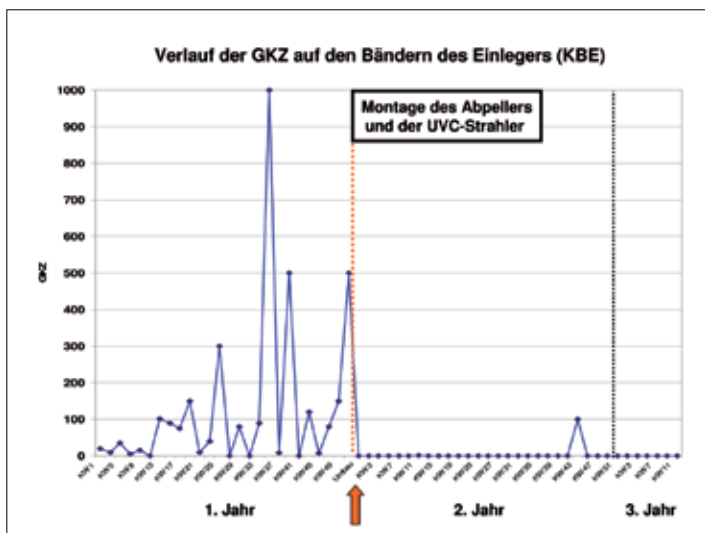
Abb. 8: Keimbelastung des Einlegers vor und nach der Installation eines AbPELLers Typ CCP und der UVC-Strahler. Das Risiko einer Verkeimung der Ware durch die Einlegerbänder kann durch die Maßnahme fast vollständig unterdrückt werden.
