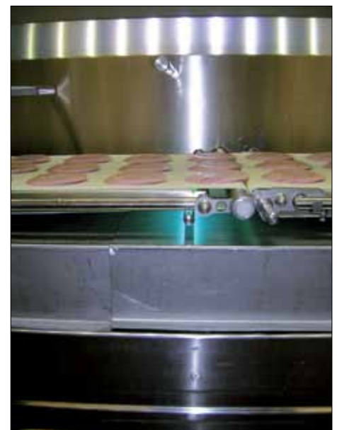
Abb. 1: UVC-Strahler an einem Slicer der Baureihe 904: An zehn Positionen der CCU und des Einlegers wurden UVC-Strahler montiert. Die Positionierung unterhalb der einzelnen Bänder führt zu hygienischen Oberflächen bei laufender Produktion.
