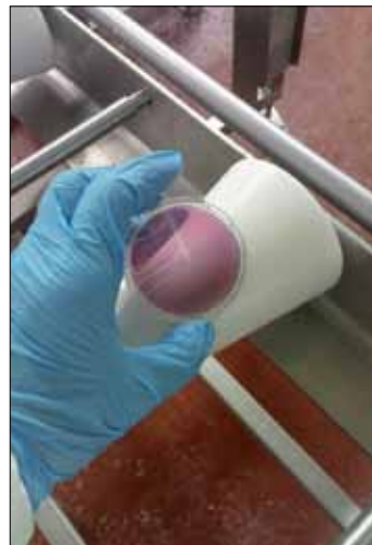
Abb. 7: Die Beprobung erfolgte mit drei verschiedenen Methoden: 1. Luftkeimsammlung zur Beurteilung der Slicerumgebung; 2. Sponge-Stick. 3. Abklatschproben mit Rodac-Platten. Zur Überprüfung der Keimquelle, gehörte auch eine Kontrolle der Eingangsware.
